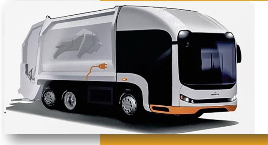
Опытный образец автомобиля-мусоровоза с автономным тяговым электрическим приводом и пониженным уровнем кабины.
